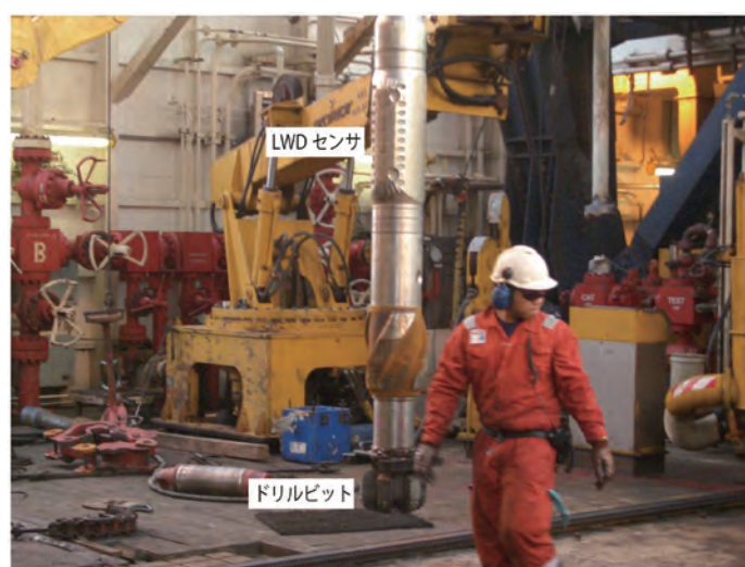
図3 ドリルビットとその上部に取り付けられたLWDのセンサ部.
