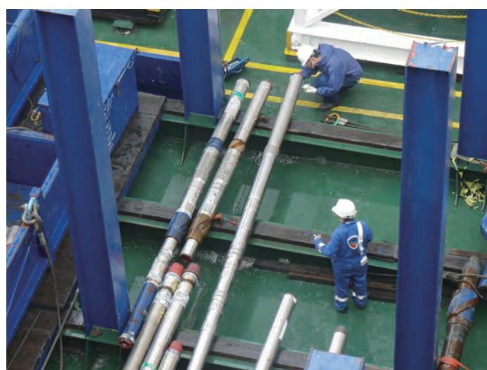
図4 LWD 機器を入念にチェックするエンジニア. これらをつなぎ合わせ長いときには約 40m もの編成になる.
