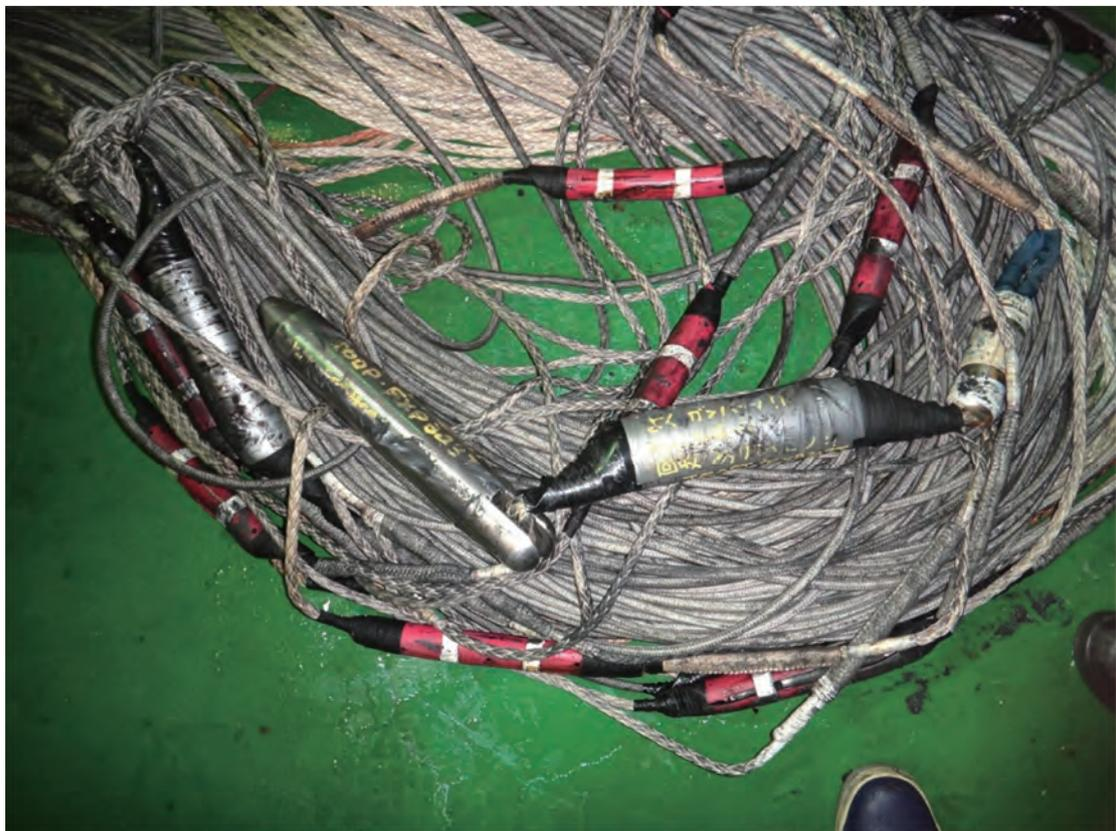
図3 水深6,889.5m, 海底下深度850.5mの地震断層から回収された孔内観測システム
