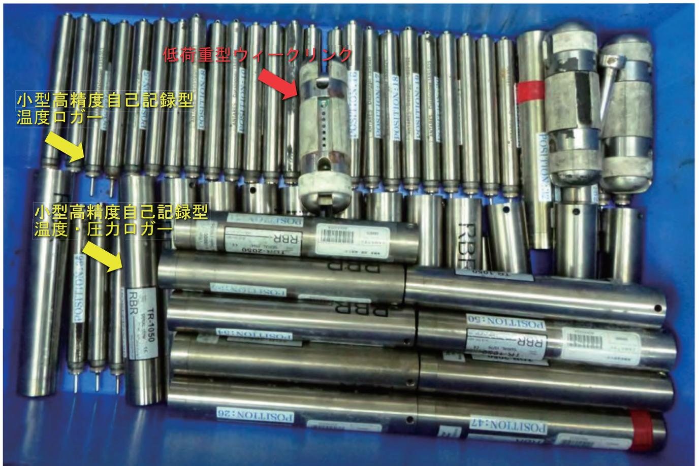
図4 孔内観測システムの構成部品(センサとウィークリンク)
